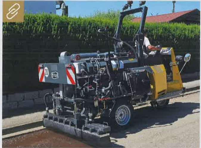
Die Selbstfahrende Vorspritzmaschine WEIRO TM 800 SH mit einem Nutzinhalt von 800 l ist für die Herstellung des Schichtenverbundes mit polymermodifizierten Bindemitteln prädestiniert. Bild: Weisig
